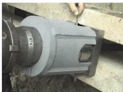
Décollement de la tête (contrôle de l'interstice entre la plaque d'appui et la tête)
