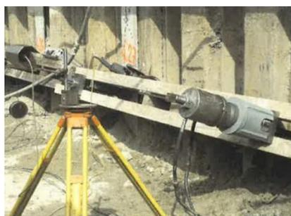
Système complet avec vérin et mesure du chemin
