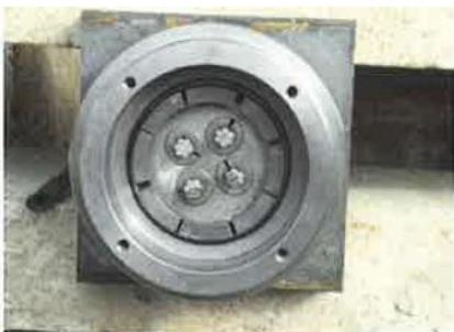
Montage du dispositif de traction sur tête d'ancrage lisse
