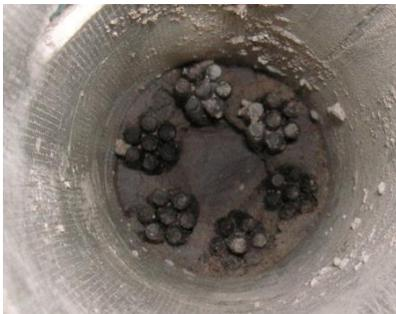
Vue intérieure après chauffage du faisceau de torons
