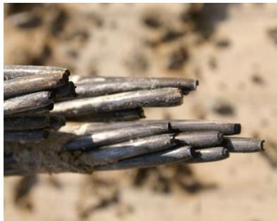
Faisceau de torons sectionnés
