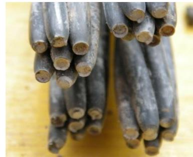
Détail de l'étranglement des torons à la rupture
