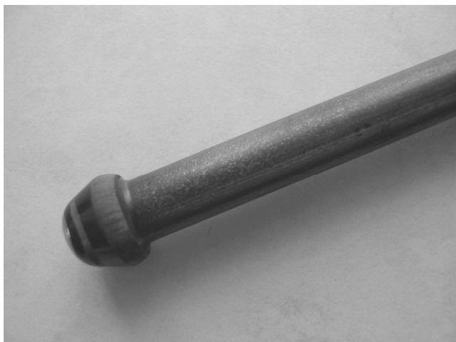
Kaltgezogener, runder Spannstahldraht  $\varnothing$  7 mm mit glatter Oberfläche.
