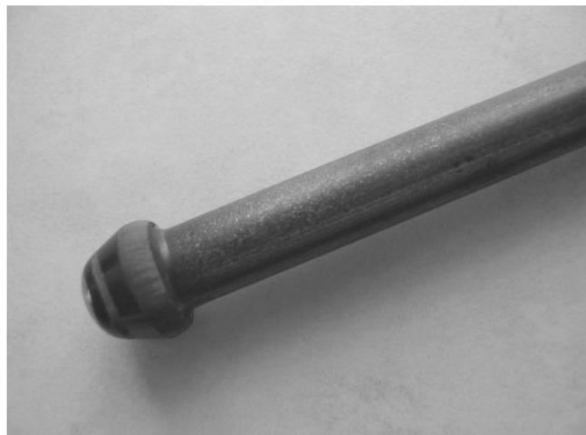
fil d'acier rond étiré à froid  $\varnothing$  7 mm avec surface lisse
